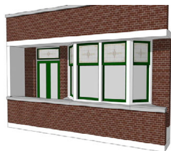
F. Bandengevel met balkon en erker met twee schuine zijden
