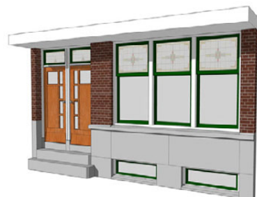
B. Straatwoongevel met één kozijn
