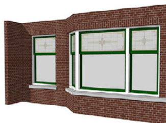
H. Gevel met schuine erker
