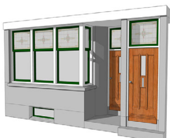
C. Straatwoongevel met hoekraam
