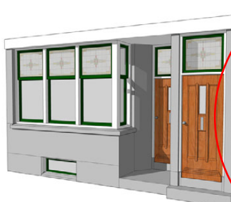
C. Straatwoongevel met hoekraam
