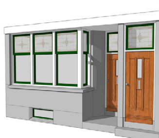
C. Straatwoongevel met hoekraam
