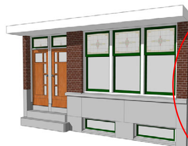
B. Straatwoongevel met één kozijn
