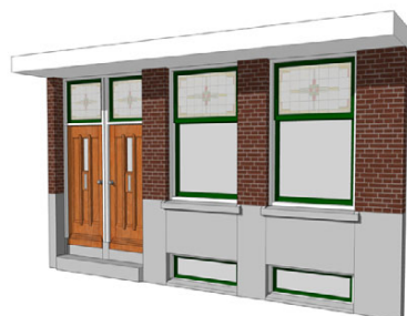
A. Straatwoongevel met losse ramen
