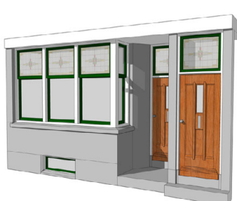
C. Straatwoongevel met hoekraam
