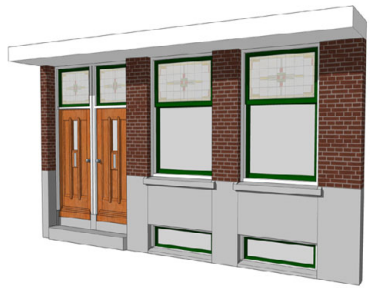
A. Straatwoongevel met losse ramen
