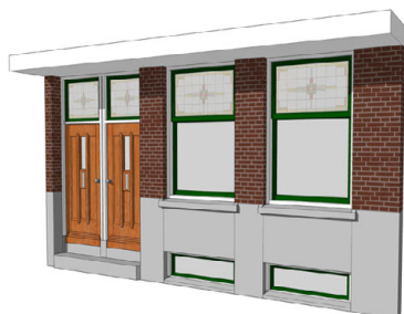
A. Straatwoongevel met losse ramen
