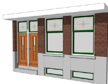
A. Straatwoongevel met losse ramen
