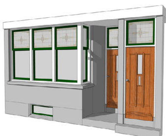
C. Straatwoongevel met hoekraam
