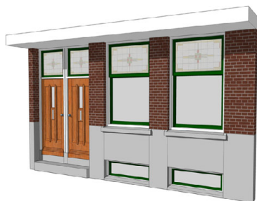
A. Straatwoongevel met losse ramen
