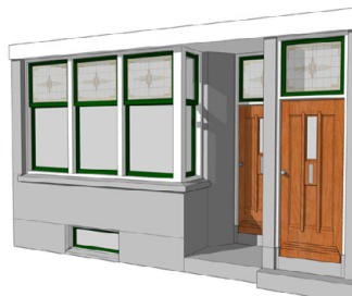
C. Straatwoongevel met hoekraam
