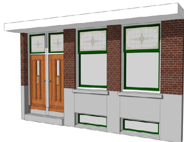
A. Straatwoongevel met losse ramen
