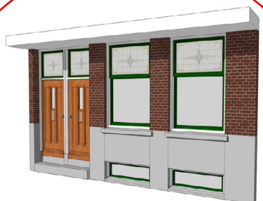
A. Straatwoongevel met losse ramen
